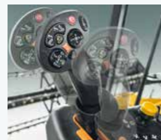
Impulzní multifunkční páka s funkcemi tempomatu s aktivní regulací
