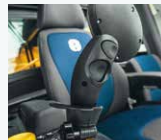
Tlačítko SHIFT a aktivace pojezdu (zadní strana multifunkční páky)
