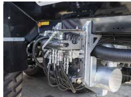
Řídicí blok Load Sensing nebo konstantní proud
