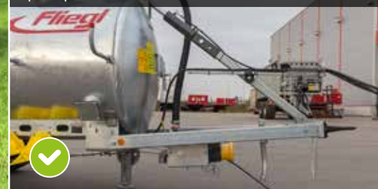
Válec ke sklápění cisterny s opěrnou patkou proti pádu od 5000 l
