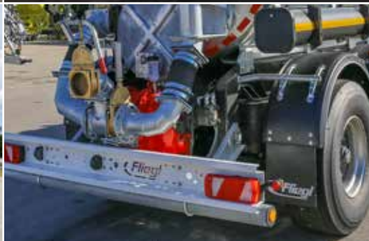
V provedení čerpadla s čerpadlem s otočnými píšťy Vogelsang
