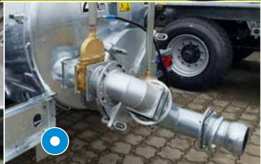
Vypouštění ze svahu (vnitřní trubkou)
