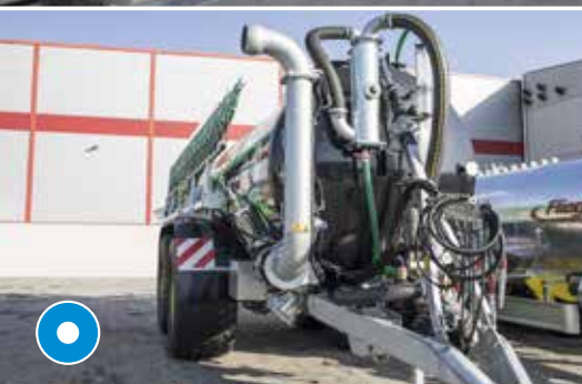
Sací hrdlo – vlevo nebo vpravo – pro pohodlné sání
