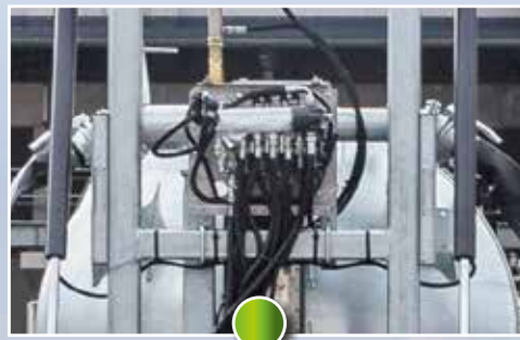
Řídicí blok s olejovým filtrem
