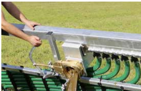
Prostor pro cizí tělesa (u systémů SKATE a GARANT), mechanické nebo hydraulické vypouštění
