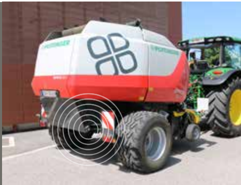
Příklad upevnění systému Beacon na balíkovacím lisu
