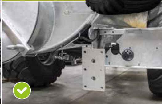
Nástavbová konzola pro vlečnou hadici nebo rozdělovač vlečné hadice SÉRIE od 5000 l
