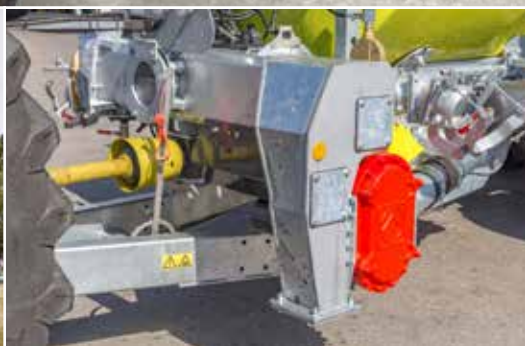
Roadx Poly Line s mechanicky poháněným pístovým rotačním čerpadlem k sání
