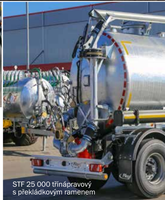
V provedení čerpadla s čerpadlem s otočnými píšťy Vogelsang
