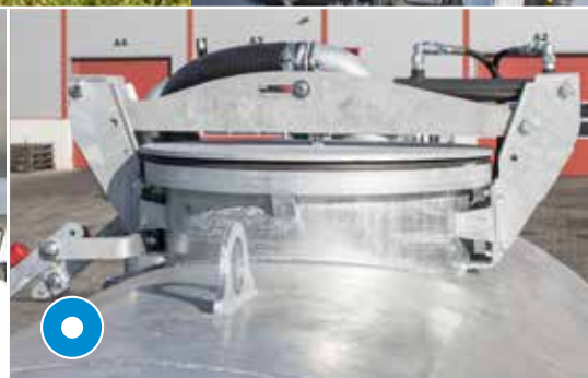
Hydraulický plnicí poklop (400 mm nebo 600 mm)
