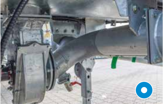
Vakuová cisterna: Turboplňení uprostřed pod cisternou
