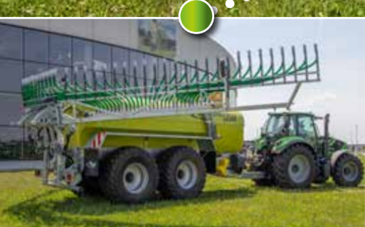
Žádné zlomené výtokové hadice pomocí speciálního sklápěcího mechanismu
