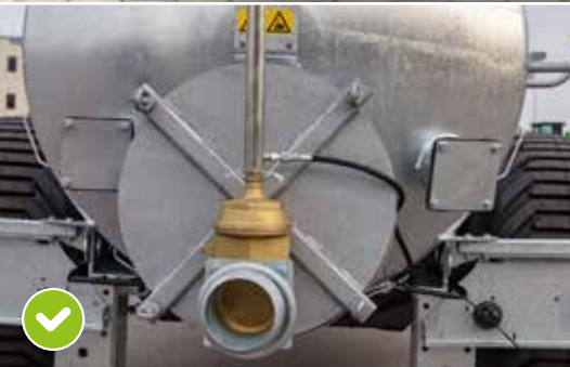
Přírubová záslepka vzadu a příprava k vypouštění ze svahu
