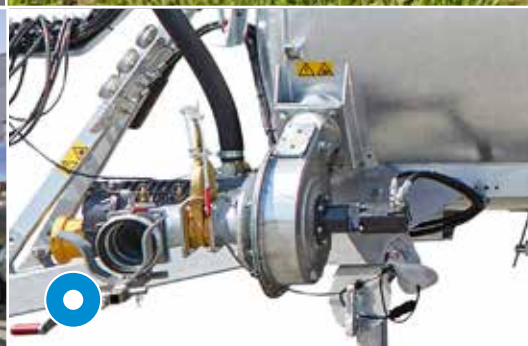
Turboplnění možné zleva nebo zprava
