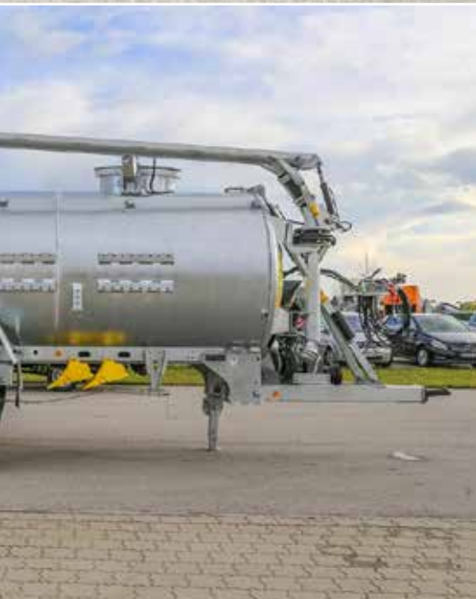
Transportní cisternový vůz se dvěma nápravami TFW 16.000
