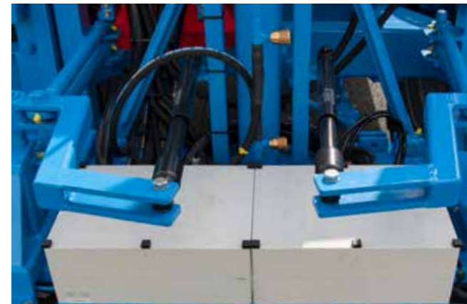
Olejové tlmiče spomaľujú pohyby ramien v oboch smeroch.
