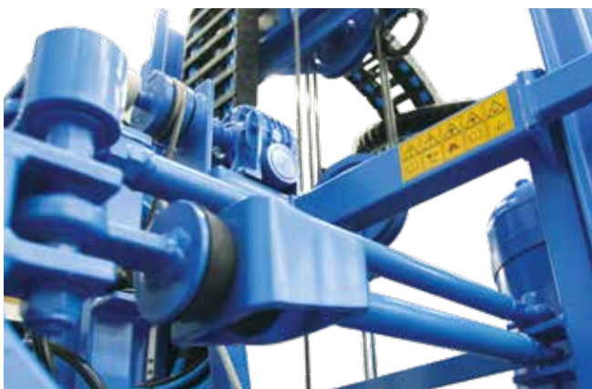
Stabilizátory znižujú kmity ramien vpred a vzad.
