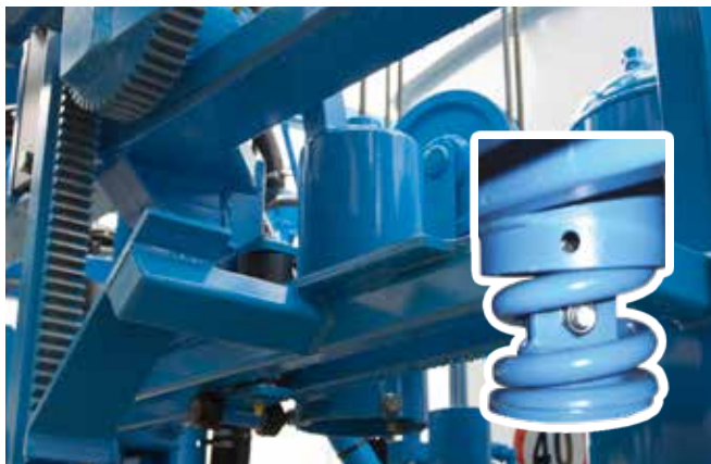
Mäkké vertikálne odpruženie ramien zaisťuje vinutá pružina.
