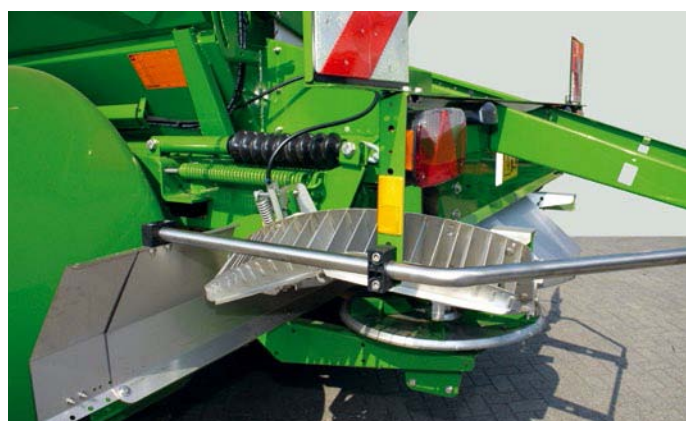
Normální hnojení s hraničním systémem Limiter vyklopeným nahoru
