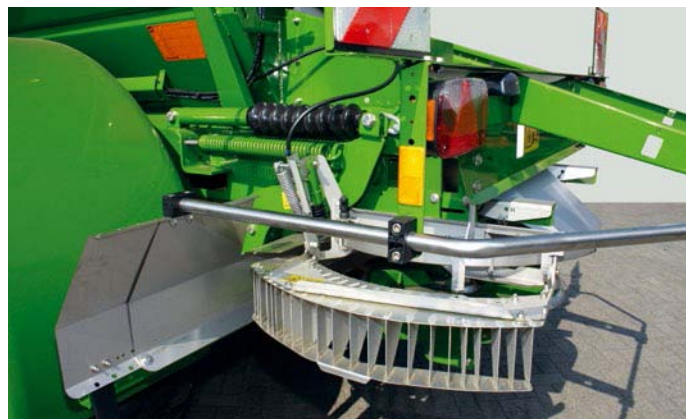
Hraniční systém rozmetání Limiter v pracovní poloze
