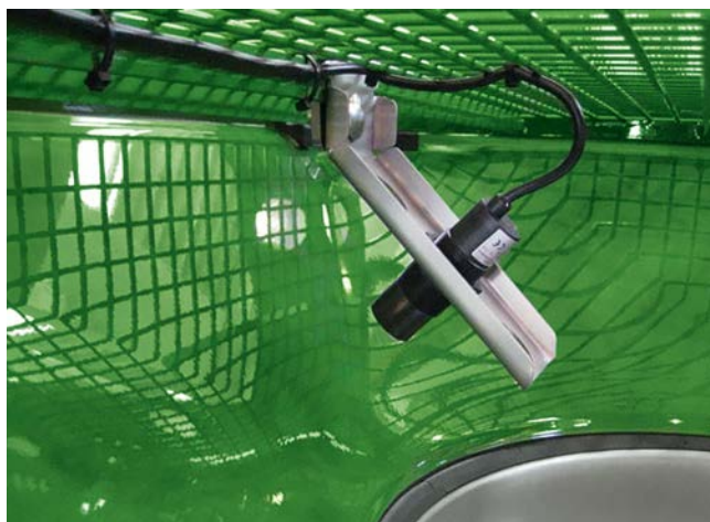
🔍 Senzor indikující vyprázdnění u rozmetadla ZA-TS
